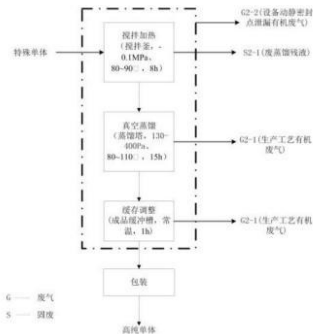
图 3.2-2 高纯单体生产工艺流程及产污环节图
